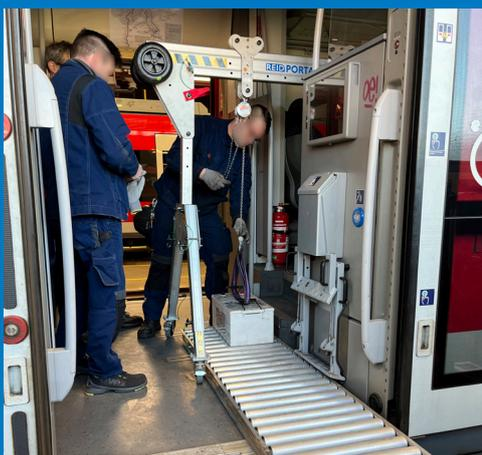
LASH + LIFT lieferte einen maßgeschneiderten **PORTAGANTRY** RAPIDE® für den DB Konzern, die große Batterien in den Zugwaggons heben und bewegen musste. Die Lösung für den engen Einsatzbereich war die Verwendung kleinerer A-Rahmen, die ein sicheres und einfaches Heben in dem begrenzten Bereich ermöglichen.
